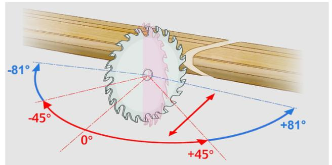
Als Sonderausführung ist die GLS mit einer Sägewinkel-erweiterung auf +/- 81 Grad erhältlich.
