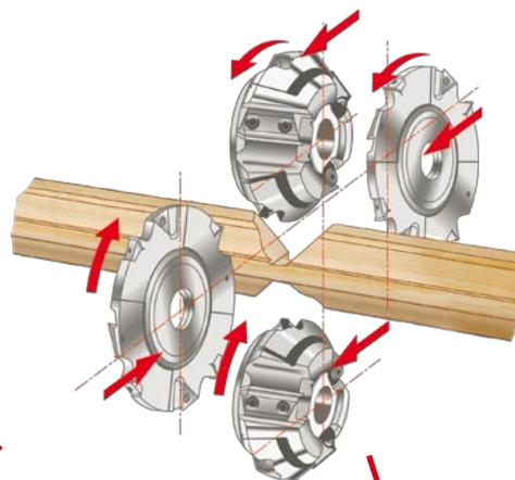
Les fraisages sont exécutés automatiquement, par deux groupes de fraisage à rotation opposée, pour un usinage des pièces profilées en un seul cycle de travail sans éclats sur la partie visible.
