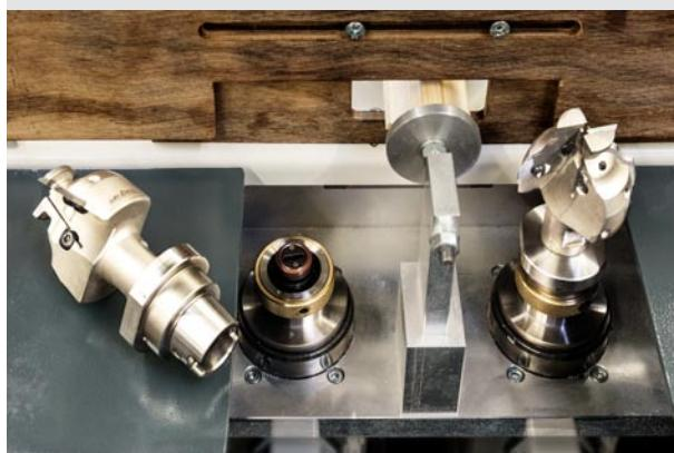
Durch einen optionalen, schnell verstellbaren Schwenkanschlag werden mit der Konterfräse KF-mini die Werkstückenden auch für Winkelanbindungen im Bereich von -45 Grad bis +45 Grad sauber gekontrahiert.
