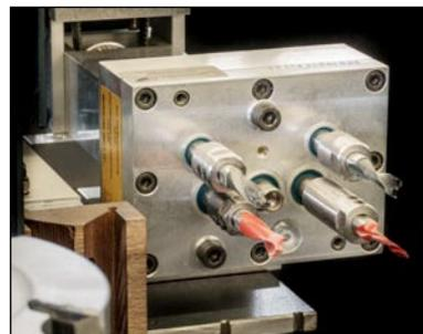
Über 3 Servoachsen gesteuertes Bohraggregat mit kundenspezifisch angepassten Mehrspindelköpfen.
